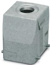
Tüllengehäuse D50, für Querbügel, Material: Aluminiumdruckguss, seewasserbeständig, Kabelabgänge: 1, gerade, 1x Pg21, Höhe: 80 mm, Kabelverschraubung: Pg21, Standard
