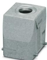
Tüllengehäuse D50, für Querbügel, Material: Aluminiumdruckguss, seewasserbeständig, Kabelabgänge: 1, gerade, 1x M25, Höhe: 80 mm, Kabelverschraubung: ohne, Standard
