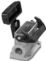
Sockelgehäuse D25, mit Längsbügel, Material: Aluminiumdruckguss, seewasserbeständig, Material Schutzdeckel: PC, Kabelabgänge: 2, seitlich, 2x Pg16, Höhe: 57 mm, Kabelverschraubung: ohne, Schutzdeckel: ja, Standard
