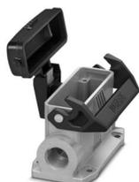
Sockelgehäuse D25, mit Längsbügel, Material: Aluminiumdruckguss, seewasserbeständig, Material Schutzdeckel: PC, Kabelabgänge: 2, seitlich, 2x M25, Höhe: 57 mm, Kabelverschraubung: ohne, Schutzdeckel: ja, Standard
