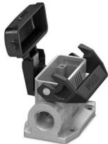
Sockelgehäuse D15, mit Längsbügel, Material: Aluminiumdruckguss, seewasserbeständig, Material Schutzdeckel: PC, Kabelabgänge: 2, seitlich, 2x M20, Höhe: 52 mm, Kabelverschraubung: ohne, Schutzdeckel: ja, Standard
