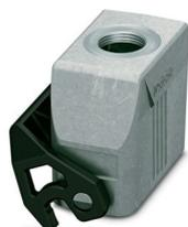
Kupplungsgehäuse D15, mit Längsbügel, Material: Aluminiumdruckguss, seewasserbeständig, Kabelabgänge: 1, gerade, 1x M20, Höhe: 52 mm, Kabelverschraubung: ohne, Standard
