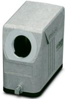
Tüllengehäuse D15, für Längsbügel, Material: Aluminiumdruckguss, seewasserbeständig, Kabelabgänge: 1, seitlich, 1x Pg16, Höhe: 56 mm, Kabelverschraubung: ohne, Standard
