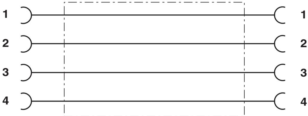
Kontaktbelegung der M12-Buchsen
