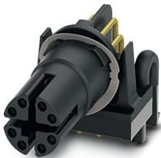
Kontaktträger, Ethernet CAT6<sub>A</sub> (10 GBit/s), 8-polig, Buchse, gewinkelt, M12, Kodierung: X, Leiterplattenmontage, Wellenlöten, dieser Artikel ist voraussichtlich ab 2025-Q4 nach RoHS II ohne Ausnahme 6c (Pb < 0,1 %) bleifrei, auf Anfrage ist eine bleifreie Alternative vorab möglich
