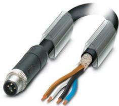
Powerleitung, 4-polig, PUR halogenfrei, schwarz RAL 9005, geschirmt (Advanced Shielding Technology), Stecker gerade M12, Kodierung: T, auf freies Leitungsende, Kabellänge: 1,5 m, für Gleichstrom bis 12 A / 63 V
