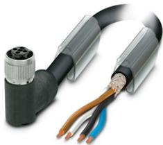
Powerleitung, 4-polig, PUR halogenfrei, schwarz RAL 9005, geschirmt (Advanced Shielding Technology), freies Leitungsende, auf Buchse gewinkelt M12, Kodierung: T, Kabellänge: 5 m, für Gleichstrom bis 12 A / 63 V
