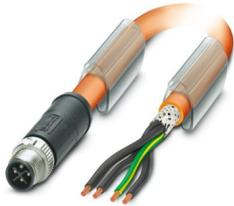
Powerleitung, 4-polig, PUR halogenfrei, orange RAL 2003, geschirmt (Advanced Shielding Technology), Stecker gerade M12, Kodierung: S, auf freies Leitungsende, Kabellänge: 3 m, für Wechselstrom bis 12 A/690 V
