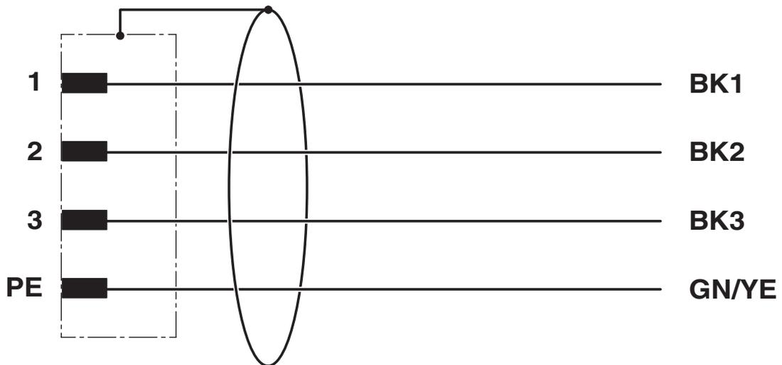
Kontaktbelegung des M12-Steckers
