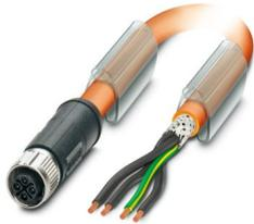
Powerleitung, 4-polig, PUR halogenfrei, orange RAL 2003, geschirmt (Advanced Shielding Technology), freies Leitungsende, auf Buchse gerade M12, Kodierung: S, Kabellänge: 5 m, für Wechselstrom bis 12 A/690 V
