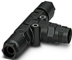
T-Verteiler, Anschlussart: IDC-Anschluss, Polzahl: 3+PE, 1 mm<sup>2</sup> ... 2,5 mm<sup>2</sup>, 690 V, 20 A, PA, schwarz, mit zwei QUICKON-Muttern, Kodierung: Kodierprofil, Leitungsaußendurchmesser: 9 mm ... 14 mm
