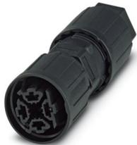
Steckverbinder, Anschlussart: IDC-Anschluss, Polzahl: 3+PE, 1 mm<sup>2</sup> ... 2,5 mm<sup>2</sup>, 690 V, 20 A, PA, schwarz, mit QUICKON-Mutter, Kodierung: Kodierprofil, Leitungsaußendurchmesser: 6 mm .
