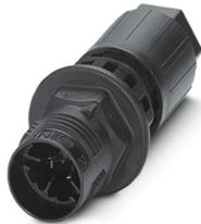
Leitungsverbinder, Anschlussart: IDC-Anschluss, Polzahl: 3+PE, 1 mm<sup>2</sup> ... 2,5 mm<sup>2</sup>, 690 V, 20 A, PA, schwarz, mit einer QUICKON-Mutter, Kodierung: Kodierprofil, Leitungsaußendurchmesser: 9 mm ... 14 mm
