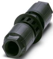
Leitungsverbinder, Anschlussart: IDC-Anschluss/ IDC-Anschluss, Polzahl: 3+PE, 1 mm<sup>2</sup> ... 2,5 mm<sup>2</sup>, 690 V, 20 A, PA, schwarz, mit zwei QUICKON-Muttern, Kodierung: Kodierprofil, Leitungsaußendurchmesser: 6 mm ... 10 mm
