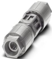
Leitungsverbinder, Anschlussart: IDC-Anschluss, 1 mm<sup>2</sup> ... 2,5 mm<sup>2</sup>, 690 V, 20 A, PA, grau, mit zwei QUICKKON-Muttern, Kodierung: Kodierprofil, Leitungsaußendurchmesser: 9 mm ... 14 mm
