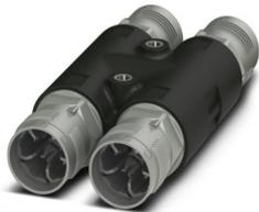
H-Verteiler, Anschlussart: IDC-Anschluss/ QUICKON-Schnellanschluss, 1 mm<sup>2</sup> ... 2,5 mm<sup>2</sup>, 690 V, 20 A, PA, grau, ohne QUICKON-Mutter, Kodierung: Kodierprofil
