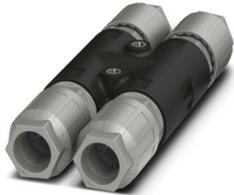
H-Verteiler, Anschlussart: IDC-Anschluss, 1 mm<sup>2</sup> ... 2,5 mm<sup>2</sup>, 690 V, 20 A, PA, grau, mit vier QUICKON-Muttern, Kodierung: Kodierprofil, Leitungsaußendurchmesser: 6 mm ... 10 mm
