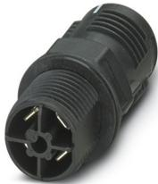
Wanddurchführung, Anschlussart: Flachsteckanschluss, Polzahl: 3+PE, M25, Stift, 1 mm<sup>2</sup> ... 2,5 mm<sup>2</sup>, 690 V, 20 A, PA, schwarz, ohne QUICKON-Mutter, Kodierung: kodiert, 2,5 mm<sup>2</sup>
