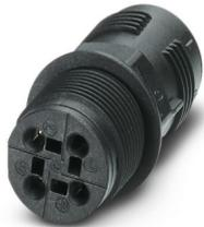
Wanddurchführung, Anschlussart: Push-in-Anschluss, Polzahl: 3+PE, M25, Stift, 1 mm<sup>2</sup> ... 2,5 mm<sup>2</sup>, 400 V, 20 A, PA, schwarz, ohne QUICKON-Mutter, Kodierung: kodiert, 2,5 mm<sup>2</sup>
