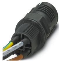
Wanddurchführung, Anschlussart: Einzeladern (angeschweißt), Polzahl: 3+PE, M25, Stift, 1 mm<sup>2</sup> ... 2,5 mm<sup>2</sup>, 690 V, 20 A, PA, schwarz, ohne QUICKON-Mutter, Kodierung: kodiert, 2,5 mm<sup>2</sup>, Adern glatt abgeschnitten, Leitungslänge: 0,5 m
