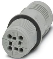
Wanddurchführung, Anschlussart: Push-in-Anschluss, Polzahl: 3+PE, M25, Stift, 1 mm<sup>2</sup> ... 2,5 mm<sup>2</sup>, 400 V, 20 A, PA, grau, ohne QUICKON-Mutter, Kodierung: kodiert, 2,5 mm<sup>2</sup>
