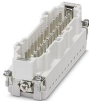
Kontakteinsatz, Polzahl: 24+PE, Baugröße: B24, Leistungskontakte: 24, Steuerkontakte: 0, Anzahl der Anschlüsse je Pol: 2, Stift, Push-in-Anschluss, 500 V, 16 A, 0,25 mm<sup>2</sup> ... 1,5 mm<sup>2</sup>, Anwendung: Leistung
