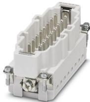
Kontakteinsatz, Polzahl: 16+PE, Baugröße: B16, Anzahl der Anschlüsse je Pol: 2, Stift, Push-in-Anschluss, 500 V, 16 A, 0,25 mm<sup>2</sup> ... 1,5 mm<sup>2</sup>, Anwendung: Leistung
