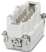
Kontakteinsatz, Polzahl: 10+PE, Baugröße: B10, Anzahl der Anschlüsse je Pol: 2, Stift, Push-in-Anschluss, 500 V, 16 A, 0,25 mm<sup>2</sup> ... 1,5 mm<sup>2</sup>, Anwendung: Leistung
