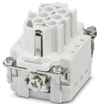
Kontakteinsatz, Polzahl: 6+PE, Baugröße: B6, Anzahl der Anschlüsse je Pol: 2, Buchse, Push-in-Anschluss, 500 V, 16 A, 0,25 mm<sup>2</sup> ... 1,5 mm<sup>2</sup>, Anwendung: Leistung
