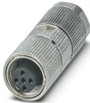
Steckverbinder, Universal, 5-polig, geschirmt, Buchse gerade M12, Kodierung: A, Crimpanschluss, Rändelmaterial: Zinkdruckguss, verzinkt, Leitungsaußendurchmesser 4,5 mm ..
