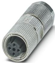
Datensteckverbinder, PROFINET CAT5 (100 MBit/s), 4-polig, geschirmt, Buchse gerade M12, Kodierung: D, Crimpanschluss, Rändelmaterial: Zinkdruckguss, verzinkt, Leitungsaußendurchmesser 4,5 mm ... 7,5 mm, ohne Crimpkontakte
