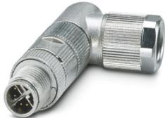
Datensteckverbinder, Ethernet CAT6<sub>A</sub> (10 GBit/s), PROFINET CAT6<sub>A</sub> (10 GBit/s), 8-polig, geschirmt, Stecker gewinkelt M12, Kodierung: X, Crimpanschluss, Rändelmaterial: Zinkdruckguss, verzinkt, Leitungsaußendurchmesser 6,5 mm ... 10 mm, ohne Crimpkontakte
