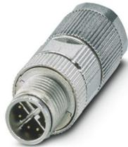
Datensteckverbinder, Ethernet CAT6<sub>A</sub> (10 GBit/s), PROFINET CAT6<sub>A</sub> (10 GBit/s), 8-polig, geschirmt, Stecker gerade M12, Kodierung: X, Crimpanschluss, Rändelmaterial: Zinkdruckguss, verzinkt, Leitungsaußendurchmesser 6,5 mm ... 10 mm, ohne Crimpkontakte
