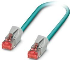
Netzwerkkabel, RJ45/IP20 gerade auf RJ45/IP20 gerade, Kabellänge: 45 m, Polzahl: 4, 100 MBit/s, CAT5, Ethernet, 2x2xAWG26/7, SF/UTP, wasserblau RAL 5021
