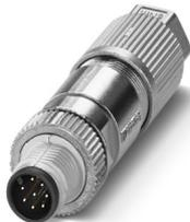
Datensteckverbinder, Ethernet CAT5 (1 GBit/s), 8-polig, halogenfrei, geschirmt, Stecker gerade M12, Kodierung: A, Schneidklemmanschluss, Rändelmaterial: Zinkdruckguss, vernickelt, Leitungsaußendurchmesser 5 mm ... 9,7 mm
