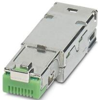
RJ45-Stifteinsatz, Bauform: RJ45, Schutzart: IP20, Polzahl: 8, 1 GBit/s, CAT5 (IEC 11801:2002), Material: Metall, Anschlussart: Schneidklemmanschluss, Anschlussquerschnitt: AWG 26- 24, Kabelabgang: gerade, Ethernet
