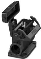
Sockelgehäuse D25, mit Längsbügel, Material: PA 6.6-FR, Material Schutzdeckel: PC, Kabelabgänge: 2, seitlich, 2x M20, Höhe: 57 mm, Kabelverschraubung: ohne, Schutzdeckel: ja, Standard, inklusiv 2x Reduzieradapter
