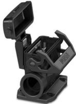
Sockelgehäuse D15, mit Längsbügel, Material: PA 6.6-FR, Material Schutzdeckel: PC, Kabelabgänge: 2, seitlich, 2x M20, Höhe: 52 mm, Kabelverschraubung: ohne, Schutzdeckel: ja, Standard, inklusiv 2x Reduzieradapter
