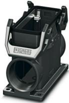
Sockelgehäuse B16, mit Querbügel, Material: PA 6.6-FR, Kabelabgänge: 2, seitlich, 2x M25, Höhe: 84 mm, Kabelverschraubung: ohne, Standard, inklusiv 2x Reduzieradapter
