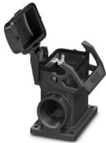
Sockelgehäuse B6, mit Längsbügel, Material: PA 6.6-FR, Material Schutzdeckel: PC, Kabelabgänge: 2, seitlich, 2x M20, Höhe: 74 mm, Kabelverschraubung: ohne, Schutzdeckel: ja, Standard, inklusiv 2x Reduzieradapter
