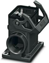
Sockelgehäuse B6, mit Längsbügel, Material: PA 6.6-FR, Kabelabgänge: 2, seitlich, 2x M25, Höhe: 74 mm, Kabelverschraubung: ohne, Standard, inklusiv 2x Reduzieradapter
