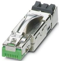
RJ45-Steckverbinder, Bauform: RJ45, Schutzart: IP20, Polzahl: 8, 1 GBit/s, CAT5, Material: Metall, Anschlussart: Schneidklemmanschluss, Anschlussquerschnitt: AWG 23- 22, Kabelabgang: gerade, Farbe: grün, Ethernet / PROFINET
