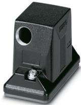
Tüllengehäuse B10, mit Schraubverriegelung, Material: Aluminiumdruckguss, seewasserbeständig, Kabelabgänge: 1, seitlich, 1x M25, Höhe: 74 mm, Kabelverschraubung: ohne, erhöhte Umwelтанforderungen
