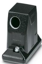
Tüllengehäuse B10, mit Schraubverriegelung, Material: Aluminiumdruckguss, seewasserbeständig, Kabelabgänge: 1, seitlich, 1x M25, Höhe: 93,7 mm, Kabelverschraubung: ohne, erhöhte Umwelтанforderungen
