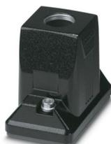
Tüllengehäuse B6, mit Schraubverriegelung, Material: Aluminiumdruckguss, seewasserbeständig, Kabelabgänge: 1, gerade, 1x M25, Höhe: 74 mm, Kabelverschraubung: ohne, erhöhte Umwelтанforderungen
