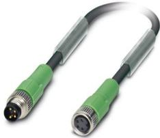
Sensor-/Aktor-Kabel, 4-polig, PUR halogenfrei, schwarzgrau RAL 7021, Stecker gerade M8, Kodierung: A, auf Buchse gerade M8, Kabellänge: 5 m
