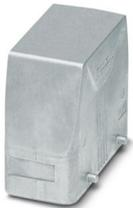
Tüllengehäuse B24, für Querbügel, Material: Aluminiumdruckguss, seewasserbeständig, variabel, Höhe: 76 mm, Kabelverschraubung: ohne, Standard, ohne Gewindeöffnung für eine Verschraubung
