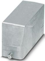
Tüllengehäuse B24, für Längsbügel, Material: Aluminiumdruckguss, seewasserbeständig, variabel, Höhe: 60 mm, Kabelverschraubung: ohne, Standard, ohne Gewindeöffnung für eine Verschraubung
