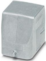
Tüllengehäuse B6, für Längsbügel, Material: Aluminiumdruckguss, seewasserbeständig, variabel, Höhe: 52 mm, Kabelverschraubung: ohne, Standard, ohne Gewindeöffnung für eine Verschraubung
