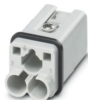
Kontakteinsatz, Polzahl: 2+PE, Baugröße: D7, Anzahl der Anschlüsse je Pol: 1, Stift, Crimpanschluss, 400 V, 40 A, 1,5 mm<sup>2</sup> ... 6 mm<sup>2</sup>, Anwendung: Leistung
