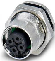
Gerätesteckverbinder Hinterwand, 4-polig, Buchse, gerade, M12-SPEEDCON, A-Kodierung, Wellenlöten, dieser Artikel ist voraussichtlich ab 2026-Q1 nach RoHS II ohne Ausnahme 6c (Pb < 0,1 %) bleifrei, auf Anfrage ist eine bleifreie Alternative vorab möglich
